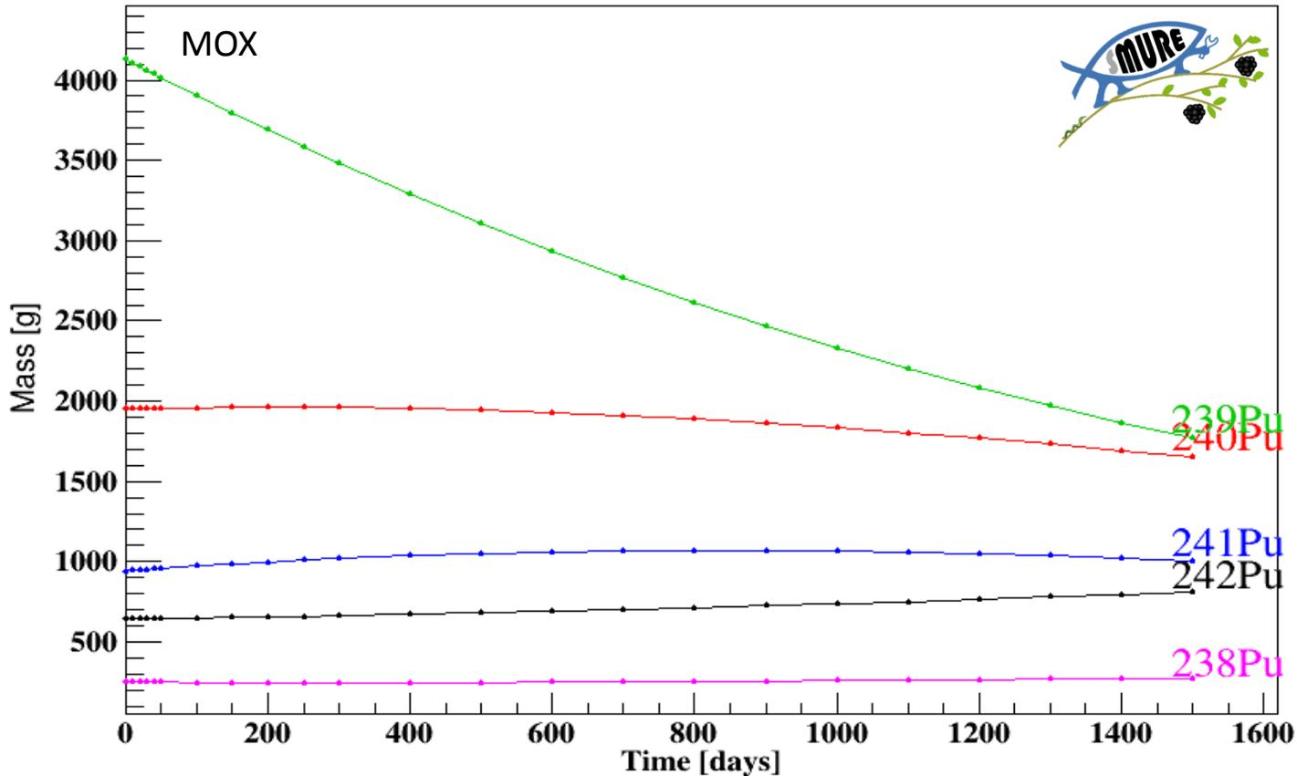
→ On brûle essentiellement du plutonium 239
