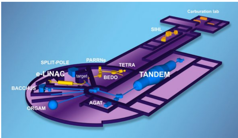
L'installation ALTO pour l'étude des noyaux radioactifs.
