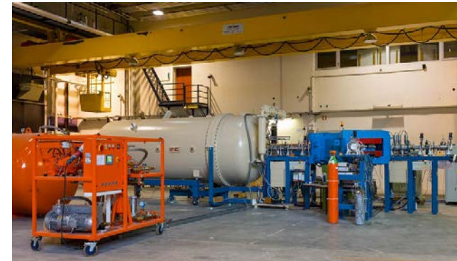
Andromède est un instrument pour l'analyse par spectrométrie de masse de nano-domaines et nano-objets présents sur une surface.
