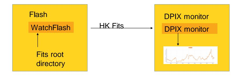
Les FITS déposés sur le disque sont automatiquement envoyés à l'application de monitor.
