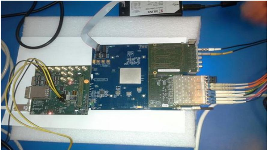
Plateforme  $\mu$ TCA instrumentée en banc de développement pour le contrôle/commande du détecteur Pixel
