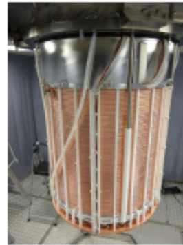
XENON1T Total Xe: 3.2 ton Target: 2 ton Fiducial: 1 ton Limit: \sim 10^{-47}
