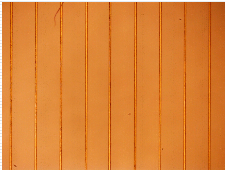
Фотография катодных 50 \mu\text{m} W/Re проволок. Шаг 0.5 мм.
