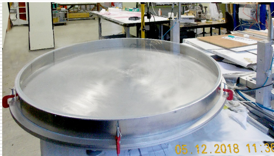
1000 мм камера для тестов на Ar/CH 4 смеси при атмосферном давлении
