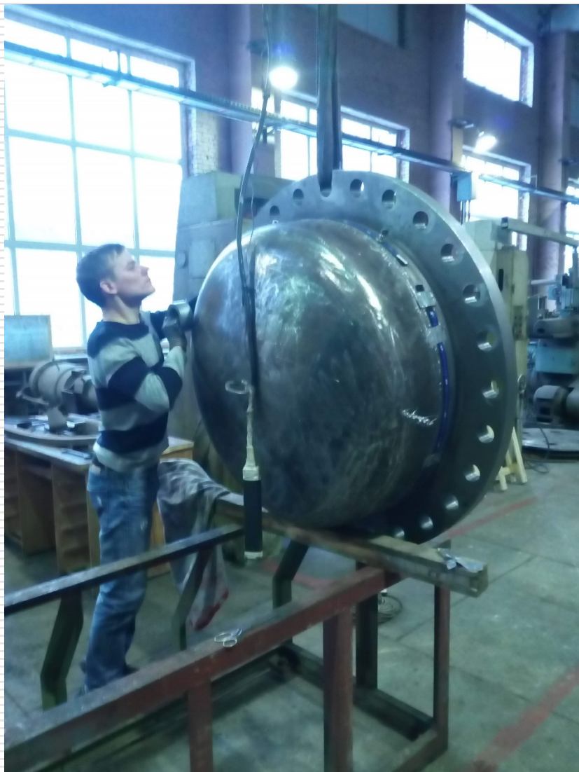
Подготовка доньшка для рентгеноскопии сварного шва
