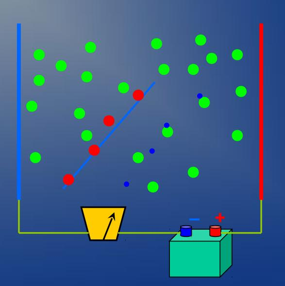
Rutherford et les Curie utiliseront la proportionnalité entre l'intensité du rayonnement ionisant et le courant électrique
