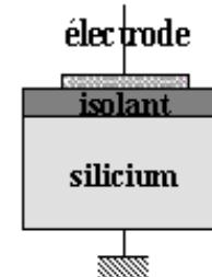
la cellule de base du capteur CCD
