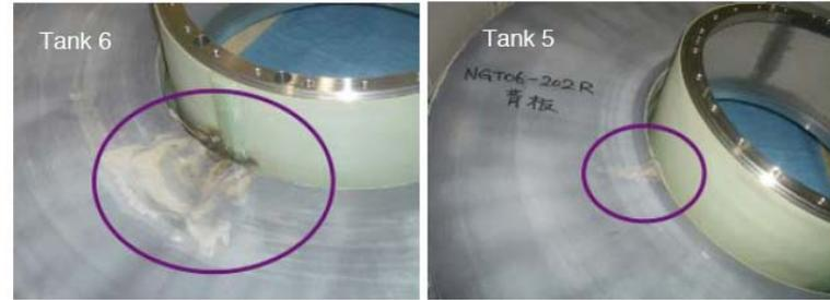
18枚中11枚のコアに損傷が見られた。予備のコア(2)を入れて4月の運転に備える。至急、新規にコアを製作。
