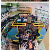
KEKB 加速器は電子と陽電子を衝突させる事により、B中間子と反B 中間 子を大量に生成する。その崩壊を観測する事で CP 対称性(粒子と反粒子 の対称性)の破れの原因を探る事が KEKB 加速器の主な目的である。B中 間子の崩壊は、電子と陽電子の衝突点を囲む Belle 測定器によって観測さ れる。
