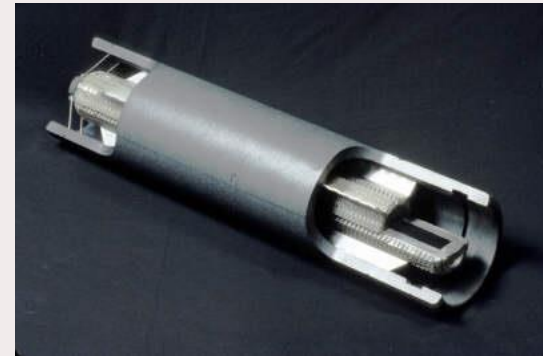
Gaine de combustible des réacteurs UNGG
