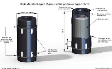
Figure 8 : Schéma d'un colis de stockage contenant le colis primaire de déchets
