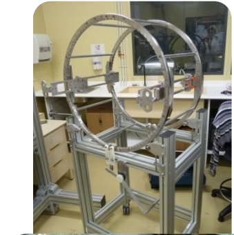
Outillage d'installation des Photomultiplicateurs
