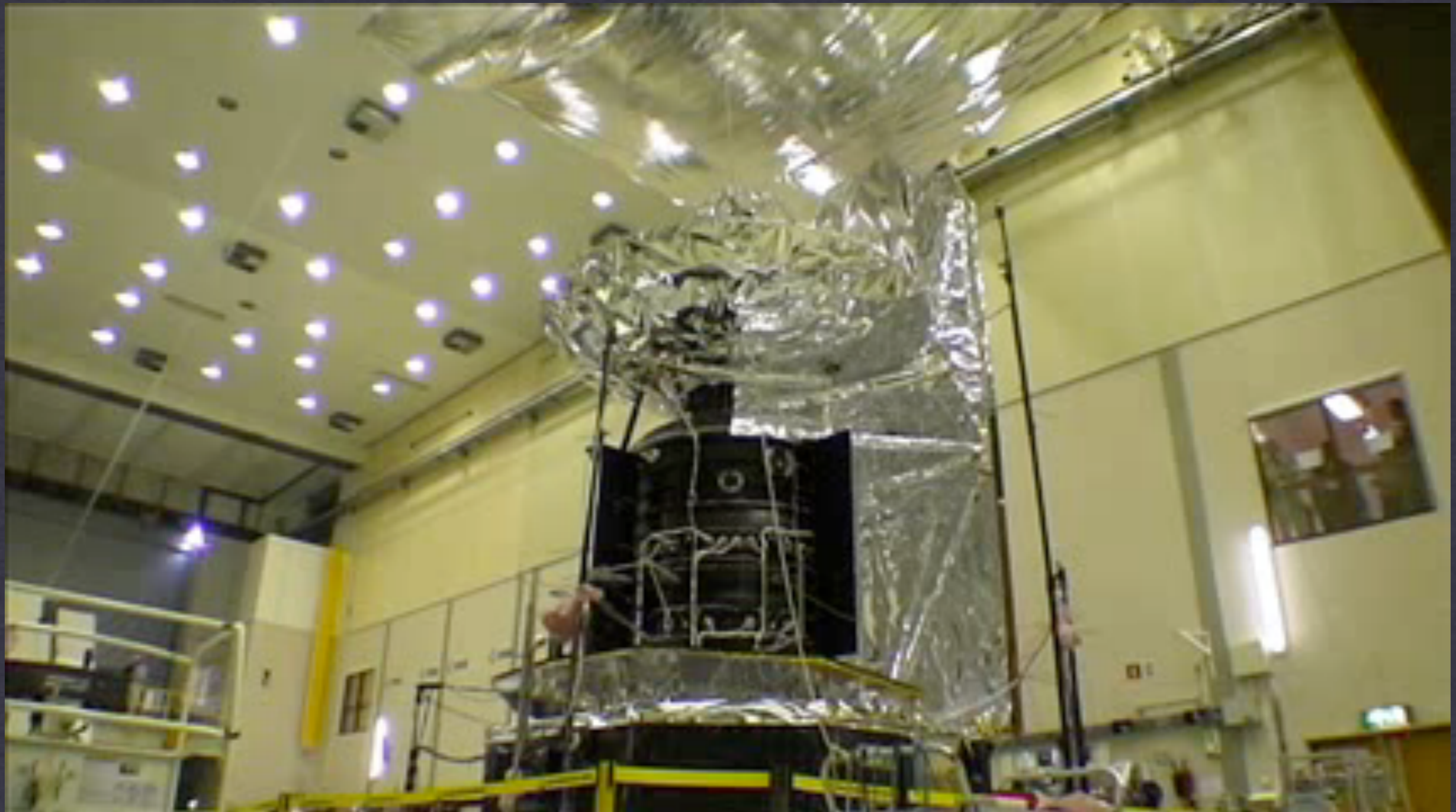
Test de vibration du satellite Herschel complet
