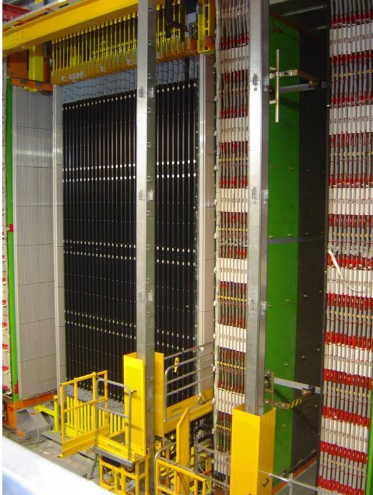
Scintillator planes 5900 m 2 8064 7m long drift tubes
