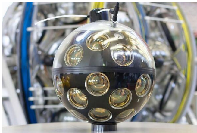
FIGURE 6: Un module optique de KM3NeT avec 31 photomultiplicateurs.
