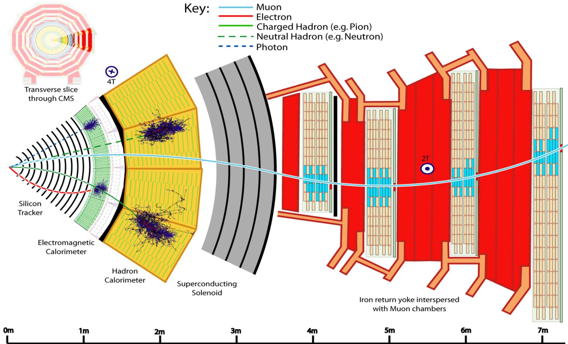
**Neutrino** : pas de trace ni dépôt d'énergie : le neutrino n'est pas détecté expérimentalement
