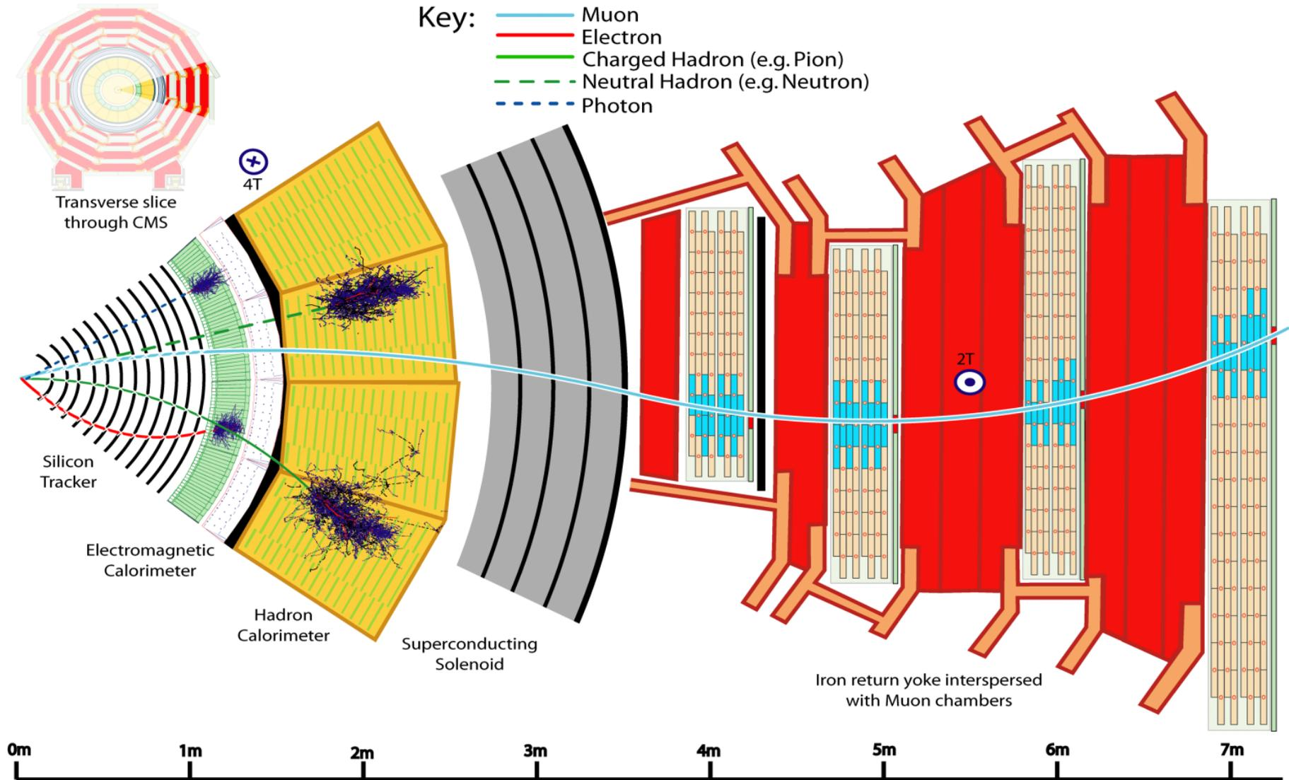
**Photon** : pas de trace chargée, dépôt d'énergie dans le calo électromagnétique
