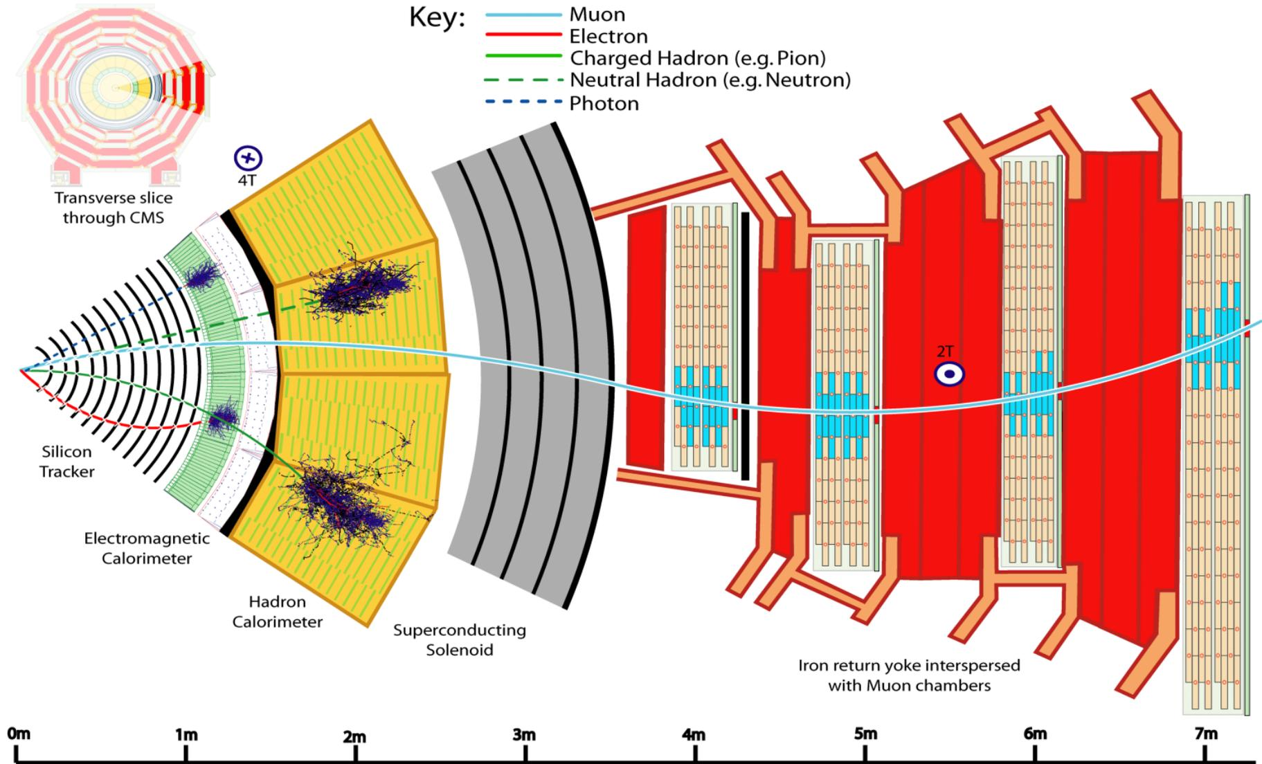
**Electron** : trace chargée dans le trajectographe et dépôt d'énergie dans le calo électromagnétique
