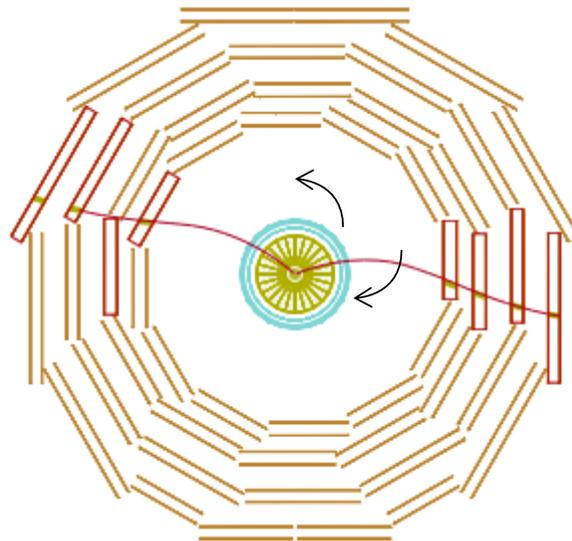
Trace courbée dans le sens des aiguilles d'une montre : charge positive ( $\mu^+$ )
