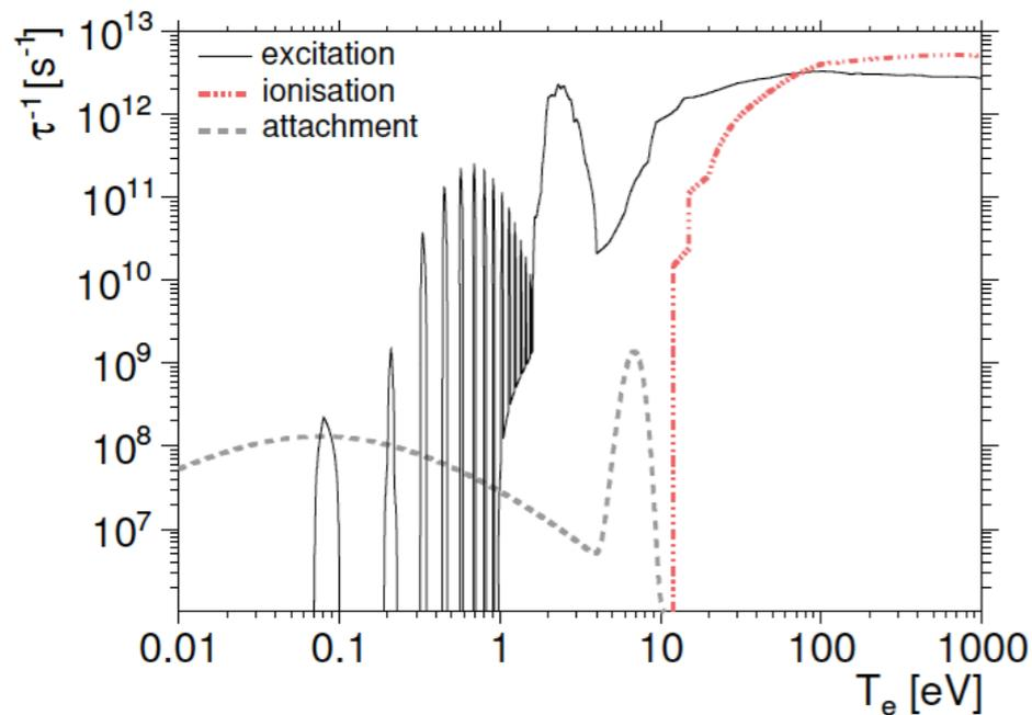
Taux de collisions des électrons secondaires en fonction de l'énergie pour plusieurs processus
