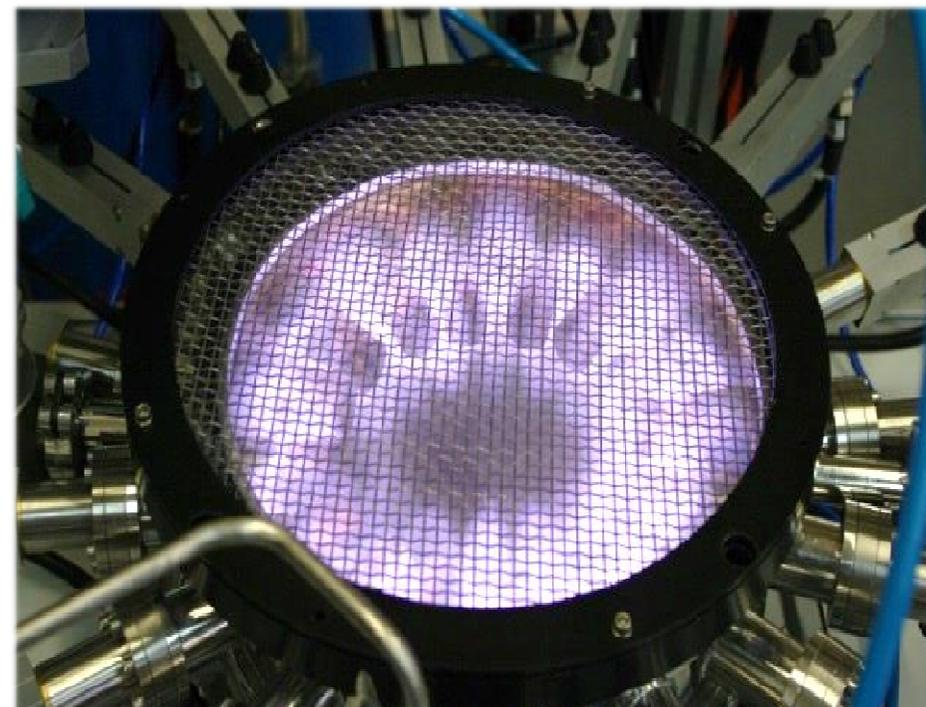
Réacteur CASIMIR pour l'étude de l'érosion de cible C/W/Al (Be-like) sous plasma de H<sub>2</sub>/D<sub>2</sub>
