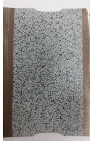
Mouchetis permettant de suivre la déformation durant l'essai.
