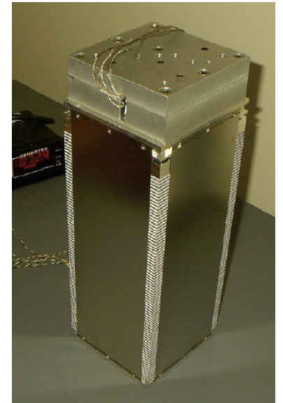
4. Ajout de straps pour assemblage final du module
