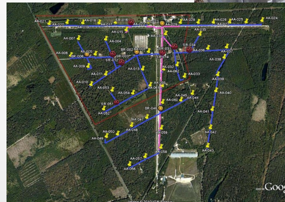
10 km de tranchées et de caniveaux le long des chemins et routes
