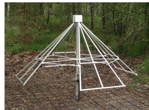
0.025 km 2 – 10 antennes câblées – Réseau phasé compact – Trigger externe
