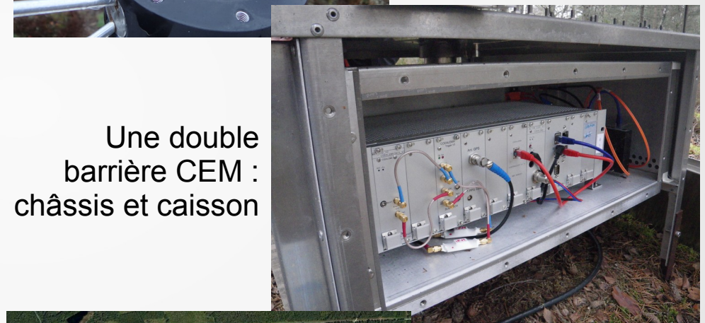
Amplificateur bas bruit 2 voies intégré dans la tête de l'antenne
