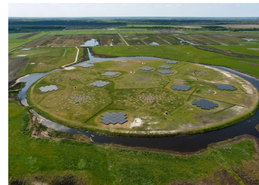
Le cœur de LOFAR aux Pays-Bas – 21x96 antennes – \varnothing = 350 m
