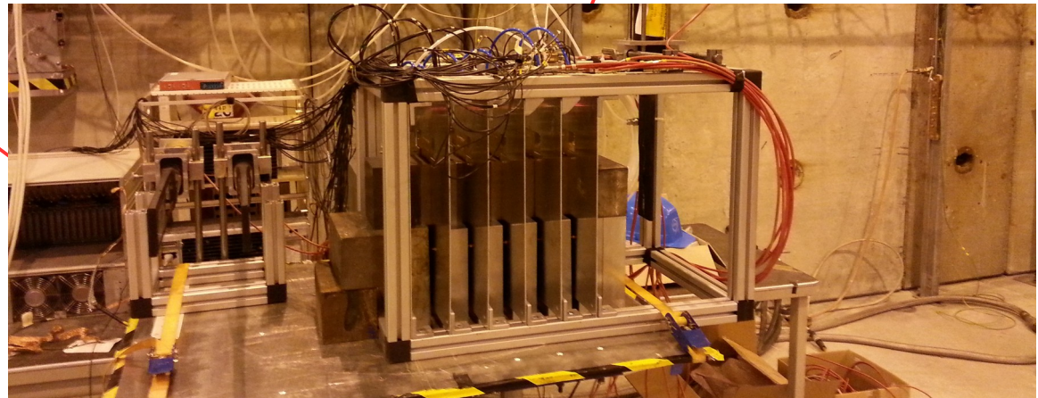
Testbeam CERN/SPS: Etincelles dans les gerbes + mini-ECAL
