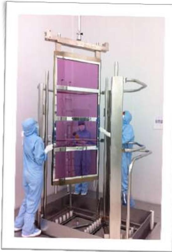
Plaques laser en cours d'assemblage
