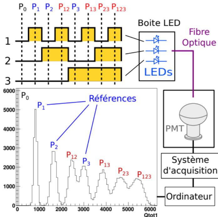
Exemple avec les patterns à 2 LEDs :  $Q_{att}(P_{ij}) = Q_{mes}(P_i) + Q_{mes}(P_j)$
