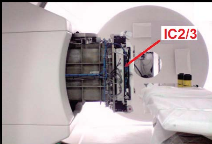
IC2/3 installée dans la nozzle d'une gantry proton
