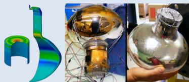
Le démonstrateur PMm<sub>2</sub> mesure le nombre de photoelectrons et leurs temps d'arrivés sur la photocathode avec un taux de perte inférieur au 4% effets du bruit inclus.
