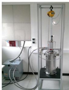
Cryostat sur machine thermique à 30 K (EUCLID)
