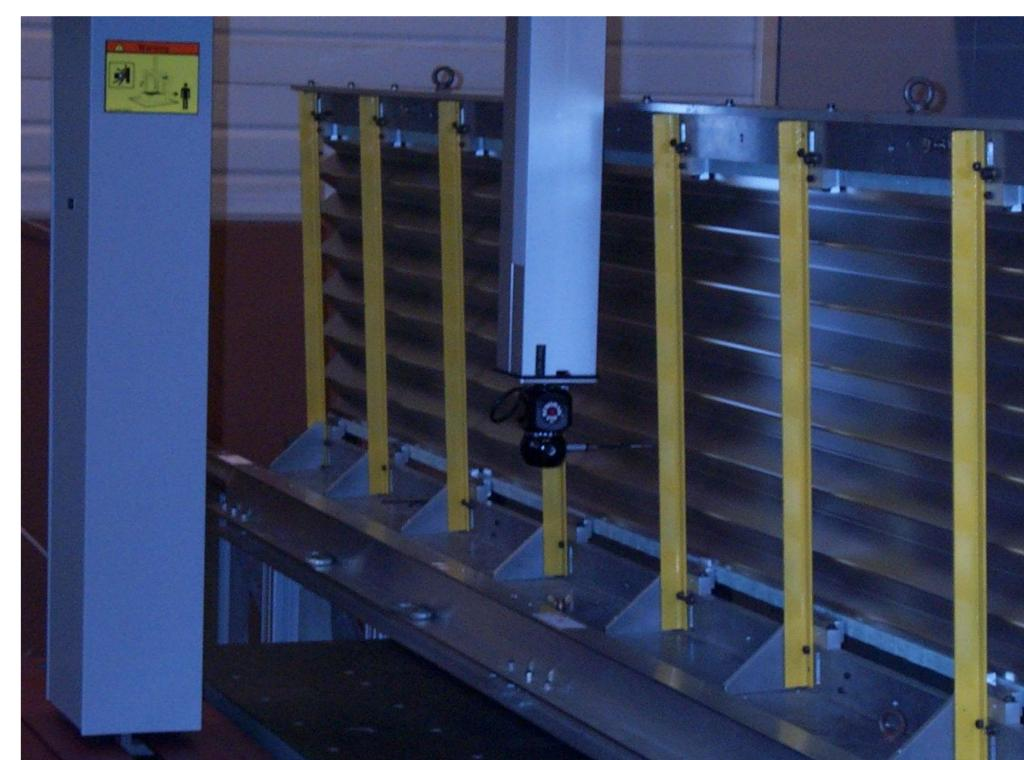
Un absorbeur mesure 3200 mm par 538,2 mm et comporte 7 ondes d'angle différent avec une tolérance de forme de <u>+</u> 50 microns. Un absorbeur est constitué d'un sandwich de plomb, d'acier inoxydable, de fibre de verre imprégnée de colle, le tout plié en accordéon.
