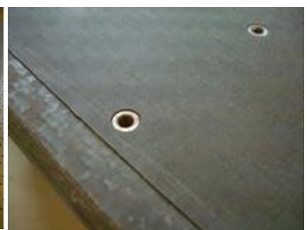
Des inserts métalliques sont noyés dans la plaque permettant la fixation des rails de guidage
