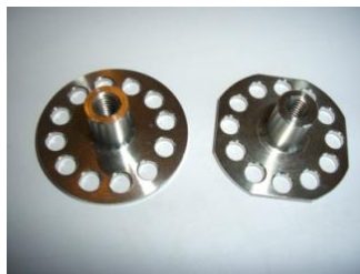
Inserts usinés LPSC – Inox amagnétique (Rp0.2 ≈ 400Mpa et Rm ≈ 680 Mpa)
