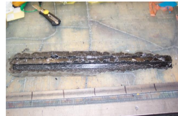
Barreau sorti de moulage, non ébarbé (démoulage à chaud)
