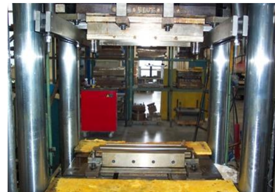
Matrice et poinçon montés sur presse chauffante 80T
