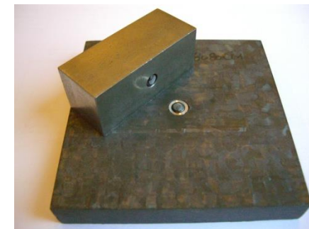
Rupture vis « fusible » / cisaillement
