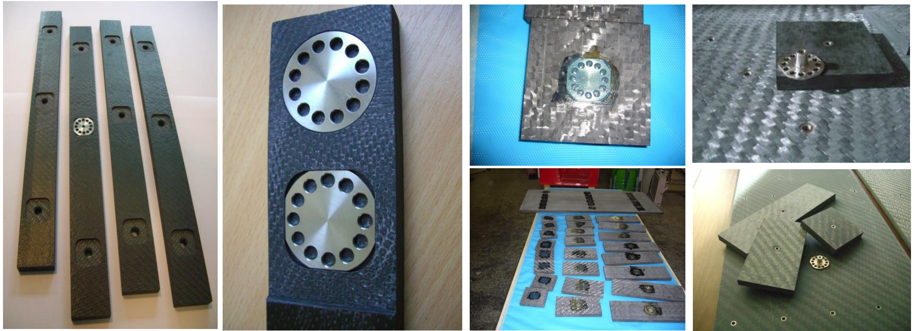
Plaque de fond et éprouvettes en fabrication (inserts collés avant drapage final – plaques finies)
