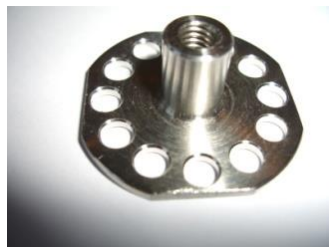
Inserts usinés LPSC – Inox amagnétique (Rp0.2 ≈ 400Mpa et Rm ≈ 680 Mpa)
