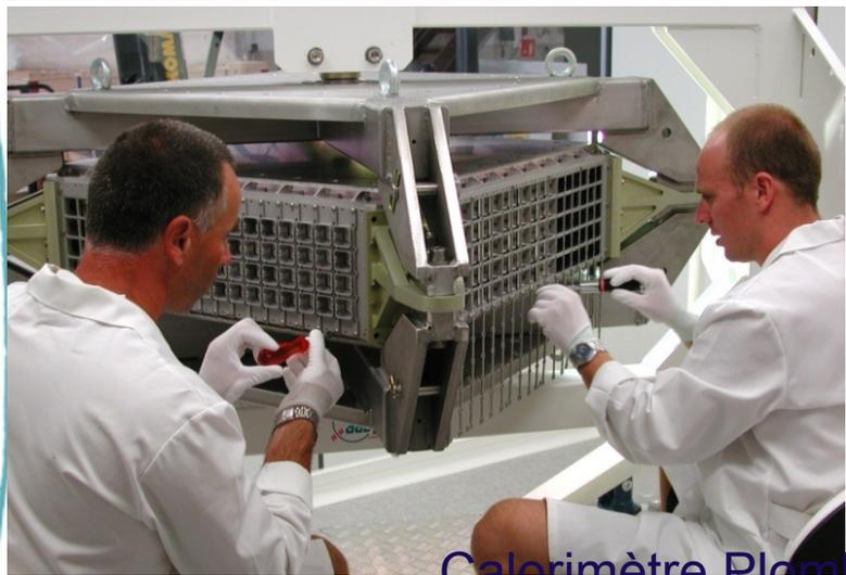
Calorimètre Plomb-Scintillateur. Poids:  $\approx 630$  kg
