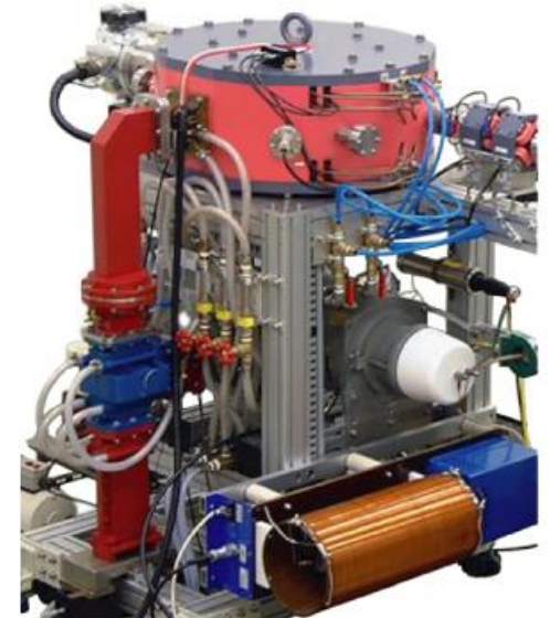
Microtron de 10 MeV 40 kW
