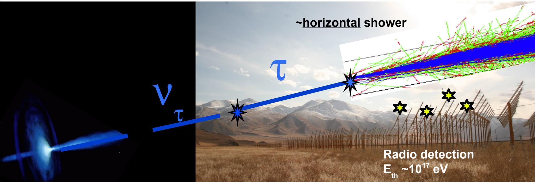
Si réjection du bruit de fond efficace démontrée par GRAND-proto, possibilité d'un réseau radio géant (100.000+ antennes sur 30.000km<sup>2</sup>+ ) pour la recherche de neutrinos cosmiques.
