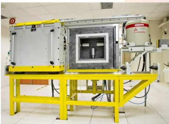
Figure a. Le spectromètre  $\gamma^3$  équipé de ses trois détecteurs germanium
