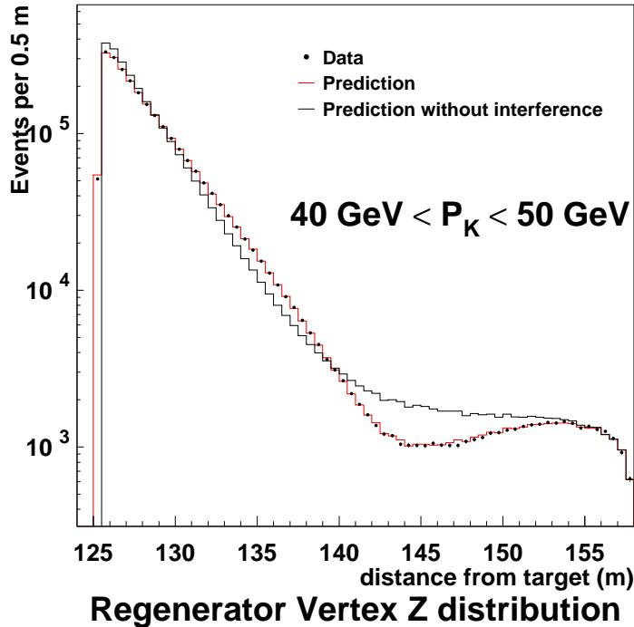
$K \rightarrow \pi\pi$  decay rate in Regenerator beam:
