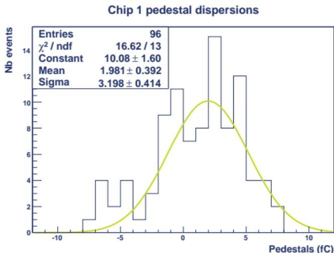
Dispersion des pedestaux un peu grande : cohérent avec l'autodéclenchement en dessous d'un seuil de 10 (8 fC).
