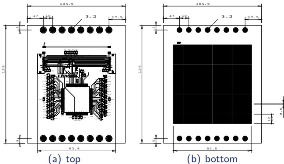
Mêmes dimensions des pads que sur les cartes « 4 Hardroc ». Pas de composants au-delà des pads pour couper les PCB au plus près. Protection Micromegas.
