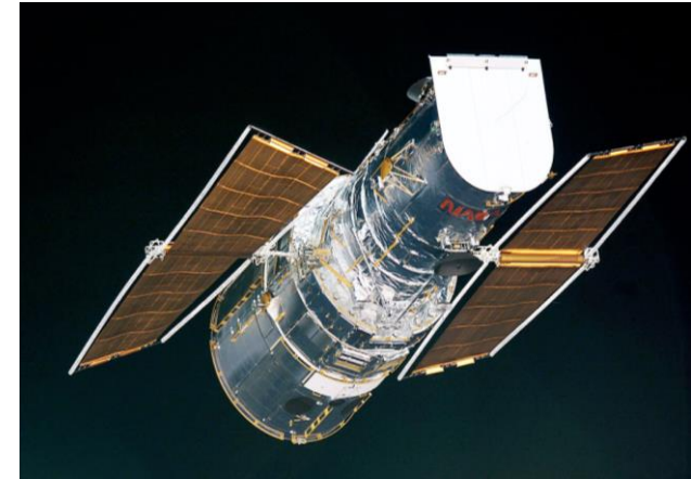
Premiers panneaux solaires du HST vieillis par le passage jour/nuit en orbite basse terrestre
