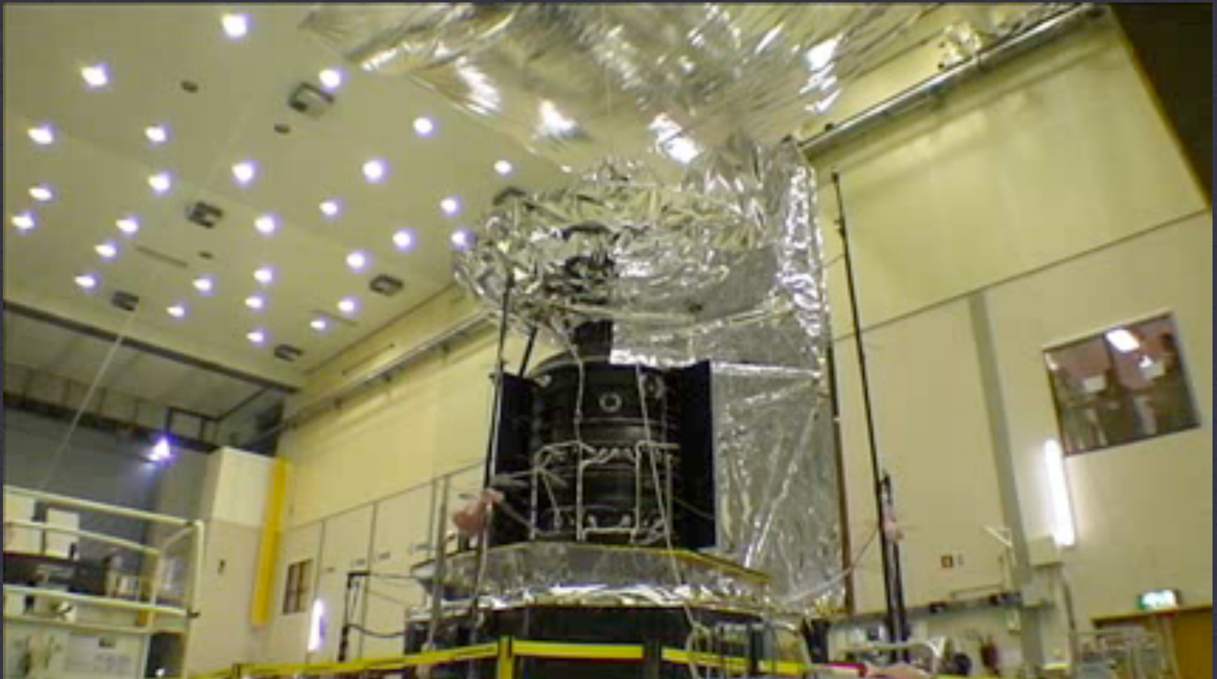
Test de vibration du satellite Herschel complet
