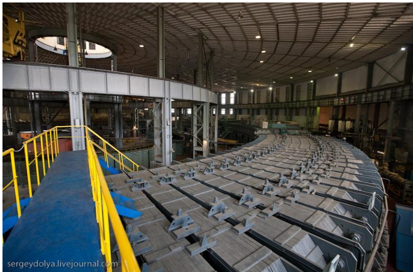
1957: Synchrotron à Dubna - 12.5 GeV
