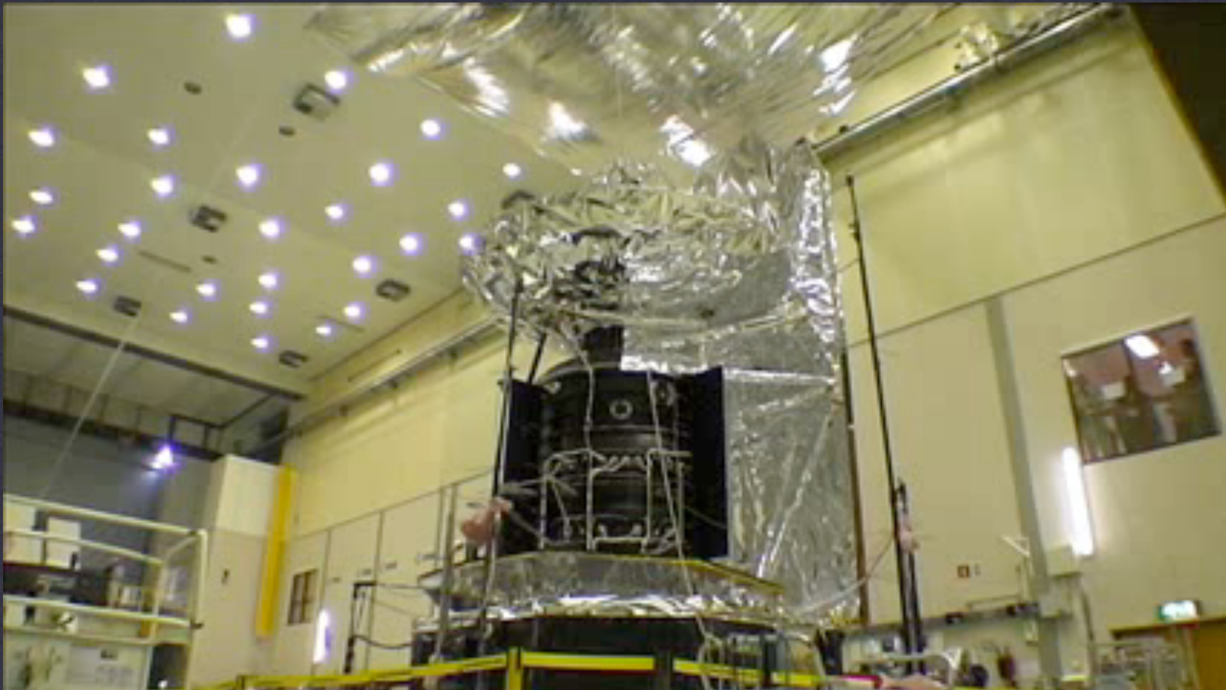
Test de vibration du satellite Herschel complet
