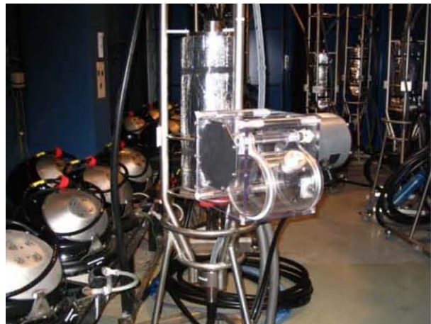
Figure 6 : Vue du système IODA6000 avant son déploiement sur une ligne d'ANTARES.
