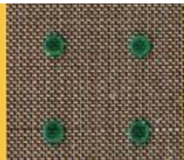
Plots de 400 microns au pas de 2 mm. Mesh inox 500 LPI
