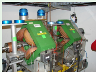
Doublet de quadripôles magnétiques :
